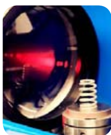
Optisk 3D analys av en skruvfjäders geometri
